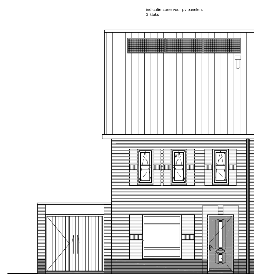
optie loopdeur in kanteledeur voorgevel
